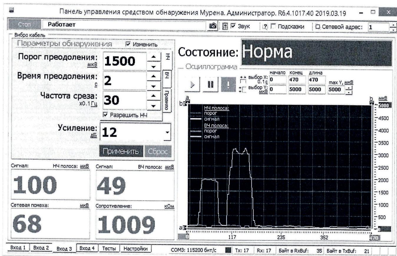
Рисунок В.7 – Установка параметров входа для ВЧЭ
